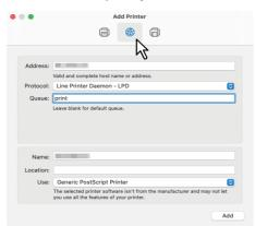
Protocol: Line Printer Daemon - LPD Address: <IP address or DNS name of this equipment> Queue: print Name: <Any Name> Location: <Any Name> Use: TOSHIBA xxxxxMFP-S2
